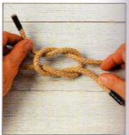
4 ... und stecke es von oben in die Bucht, parallel zu seiner eigenen festen Part.
